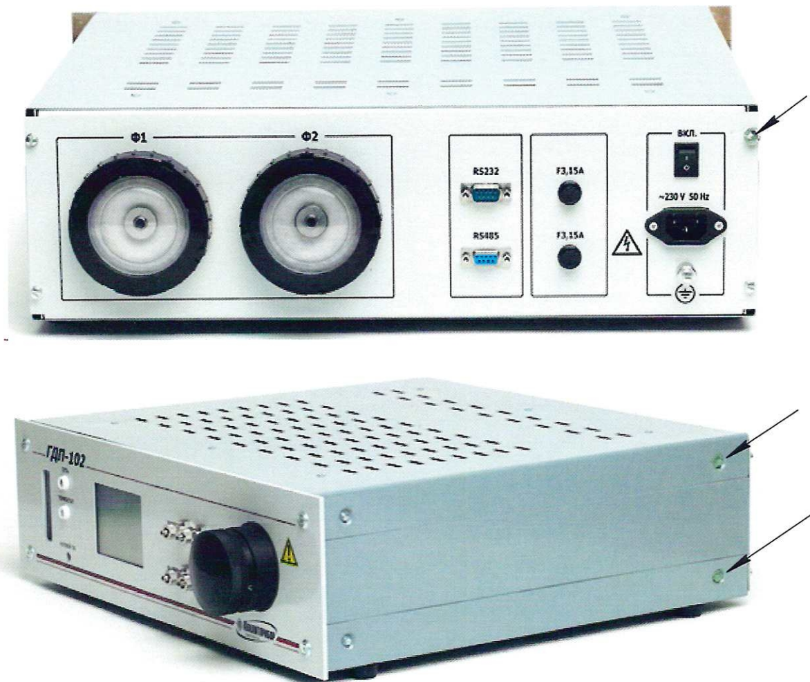
Рисунок 2 - Схема пломбировки генераторов от несанкционированного доступа, обозначение мест для нанесения оттисков клейм (показаны стрелками)
